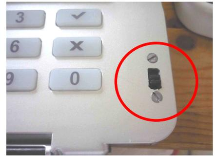
Anlage in Programmiermodus setzen. Alle 4 Busleitungen bei der MX abklemmen. Die unteren zwei Schrauben am Bedienfeld lösen und das Gehäuse vorsichtig auseinanderklappen.
