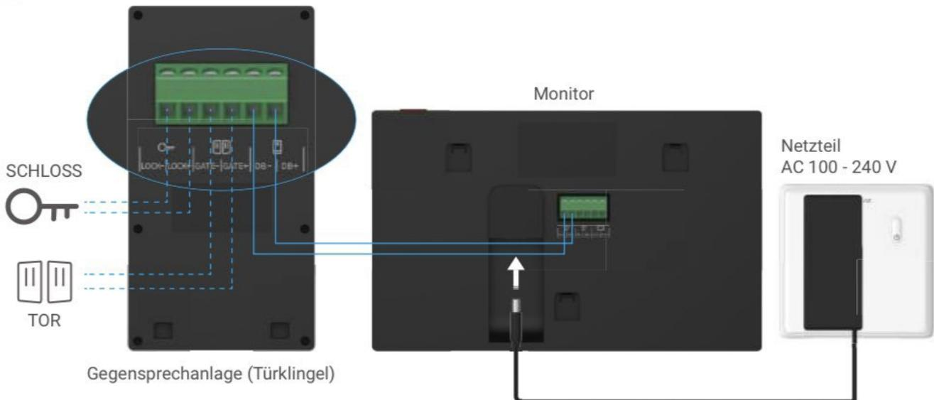
**⚠️ Warnung:** Vergewissern Sie sich, dass alle Kabel richtig angeschlossen sind, bevor Sie das Netzteil in eine Steckdose stecken.
